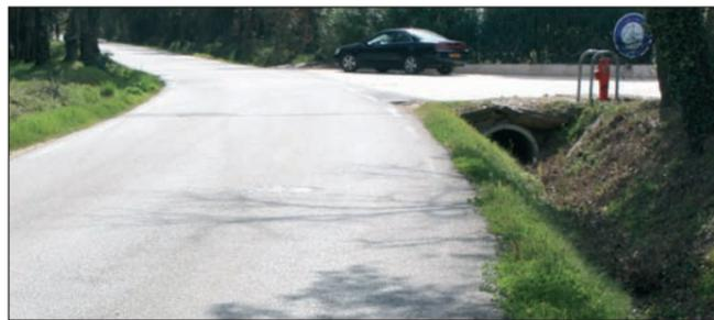
La route du Bourrian devrait subir avant l'été des travaux de sécurisation. Le projet prévoit la disparition du fossé, côté haras. Côté colline, sur le caniveau béton d'une largeur de 50 cm, une buse sera enterrée pour récolter les eaux pluviales. Dans un premier temps, la route dont la largeur (5,50m) ne sera pas
