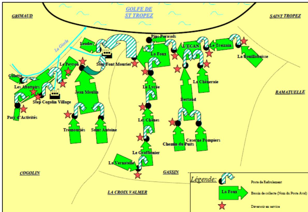
Schéma de principe du réseau de collecte
